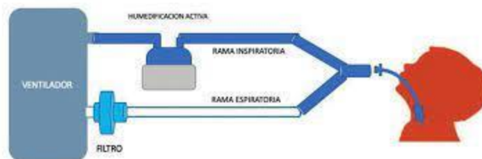
Fig. 2 Circuito de paciente para conexión a ventilador. Se muestra gráficamente la forma correcta de realizar la conexión de la interfaz de circuito de tubos con humidificación activa, que funge como comunicación entre el equipo de ventilación mecánica y paciente crítico.
