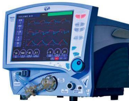
Fig. 3 Ventilador VIASYS VELA. El sistema de suministro de gas de este ventilador provee volúmenes exactos con gran precisión dentro de un rango comprendido entre los 2 ml y los 2,5L. Su sensor de flujo de tres capas utiliza un sistema de algoritmo de respuesta en bucle cerrado, proporcionando así una medición precisa del flujo de hasta 0.4 L/min.
